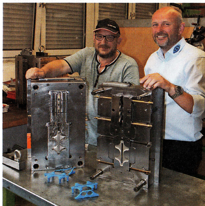
Alexander Brock (li.) und Frank Vollmer mit den beiden Hälften des bei VKT gebauten Werkzeugs sowie den Entriegelungsgriffen aus PP, die damit gespritzt werden. Foto: Mecadat
