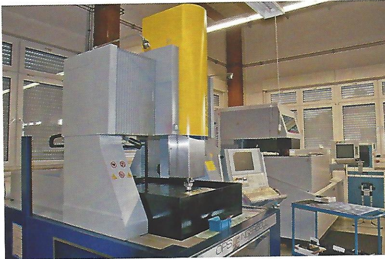
Neben dem Fräsbereich ist bei Vollmer Kunststofftechnik auch das Senkerodieren mit dem Modul Elektrode sowie das Drahterodieren mit PEPS Wire komplett in den Visi-CAD-CAM-Workflow eingebunden.
