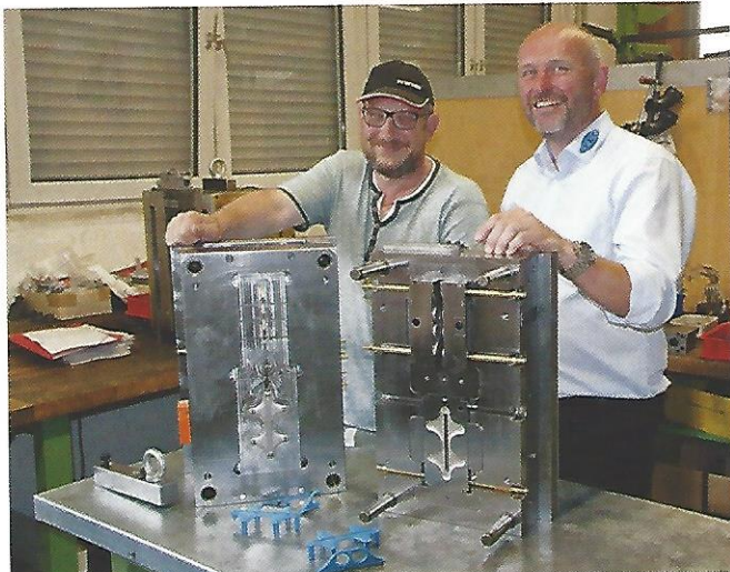
Alexander Brock und Werkzeugbauunternehmer Frank Vollmer mit den beiden Hälften des bei VKT gebauten Werkzeugs sowie die Entriegelungsgriffe aus Polypropylen, die damit gespritzt werden.
