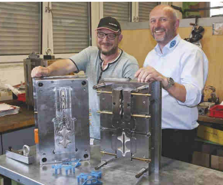
Alexander Brock (li.) und Frank Vollmer (re.) mit den beiden Hälften des bei VKT gebauten Werkzeugs sowie den Entriegelungsgriffen aus PP, die damit gespritzt werden. Bild: Mecadat
