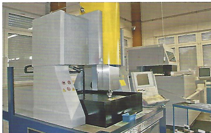
Neben dem Fräsbereich ist bei VKT auch das Senkerodieren mit dem Modul Elektrode sowie das Drahterodieren mit PEPS Wire komplett in den VISI-CAD-CAM-Workflow eingebunden.
