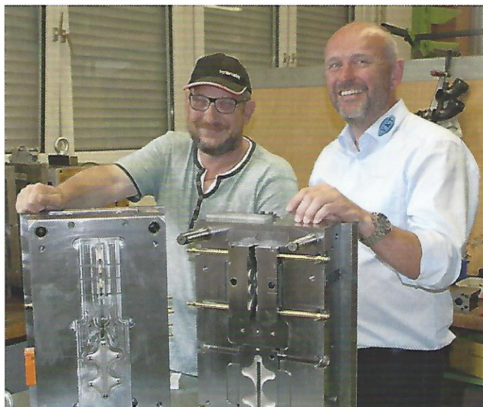
Alexander Brock und Frank Vollmer mit den beiden Hälften des bei VKT gebauten Werkzeugs sowie die Entriegelungsgriffe aus PP, die damit gespritzt werden.
