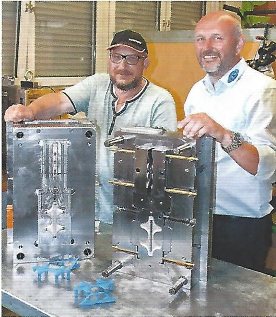
Alexander Brock und Frank Vollmer mit den beiden Hälften des bei VKT gebauten Werkzeugs sowie Entriegelungsgriffen aus PP, die damit gespritzt werden.
